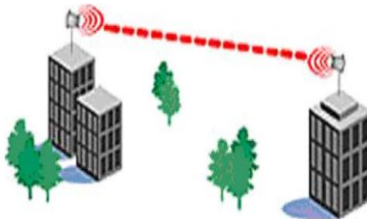
Figura 2. 3: Enlace PTP (Punto a Punto). Fuente: (Pastor Ponce, 2015)
