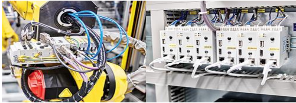
Figura 2. 18 Válvulas neumáticas (izquierda) conectadas a “concentradores” de monitoreo neumático (derecha).
