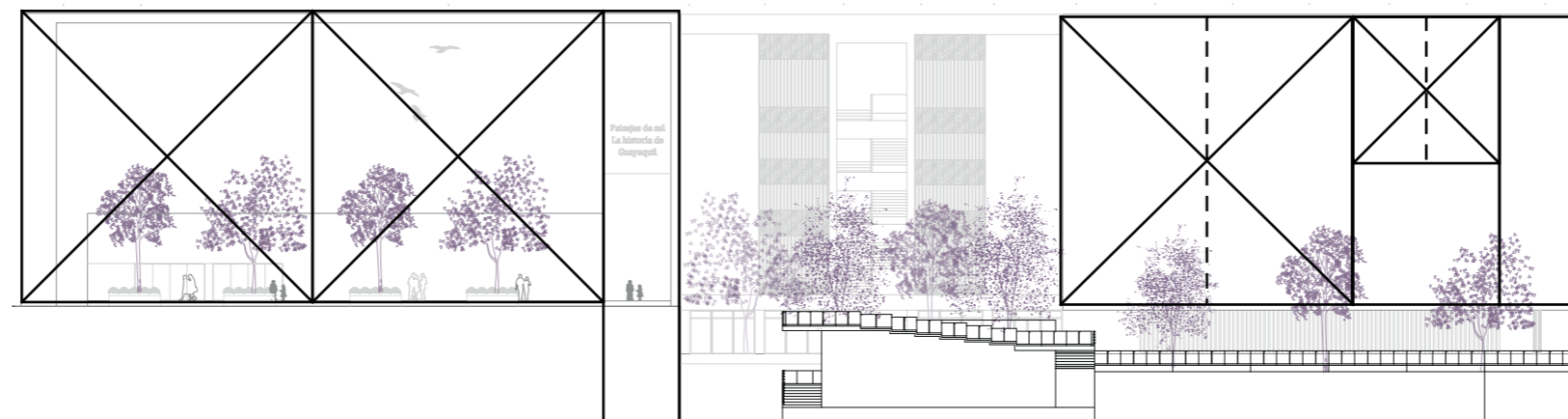
El ritmo de la fachada se compone por dos hileras de cuadrados que a su vez dividiendolos por la mitad en proporción 1:2 forman un rectángulo doble cuadrado, la hilera inferior responde al nivel de suelo manejado al interior del proyecto
