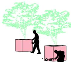
Se desplazan con la ayuda de llantas (escondidas bajo una tapa) y se fijan en el sitio con frenos.
