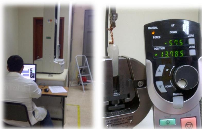
**Fig. No. 43:** Tensionamiento previo del alambre de cobre
