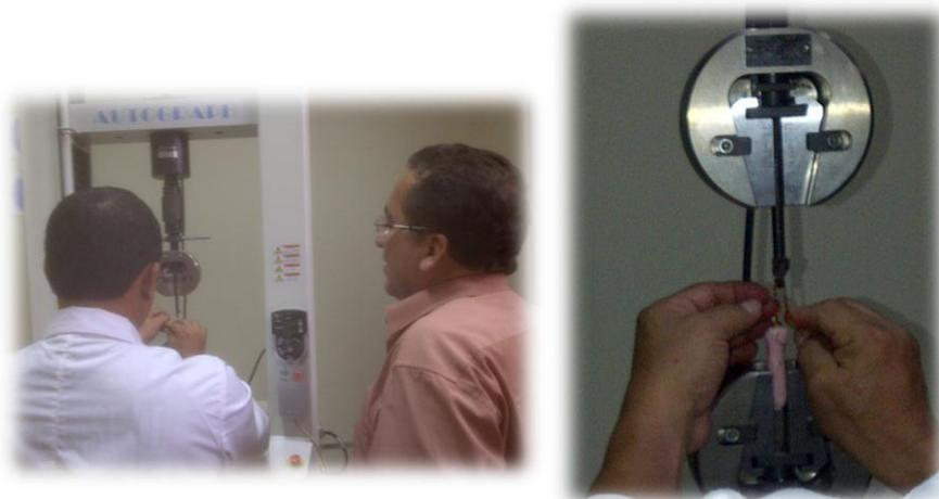
**Fig. No. 42:** Colocación de las muestras y ajuste con el alambre de cobre
