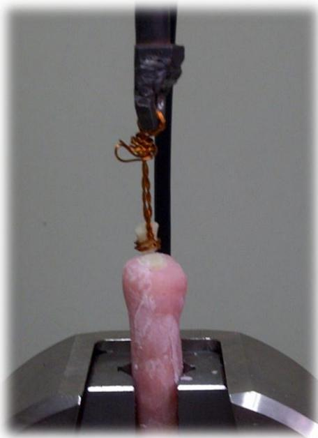
**Fig. No. 44:** Muestra lista para inicio de los ensayos de tracción
