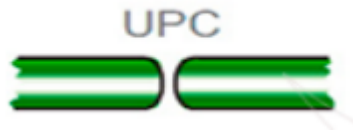
Figura 2. 32 Férula con pulido UPC Fuente: (Alvarez, 2017)
