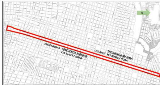
Figura 2. 3. Ruta del Corredor vial 2 de Guayaquil. Fuente: (A & V Consultores, 2016).
