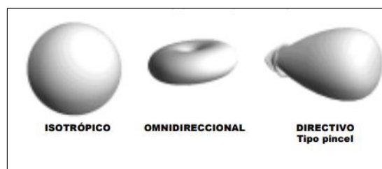
Figura 2. 20. Diagrama de radiación de antenas Isotrópica, Omnidireccional y Directivo. Fuente: (Serrano, 2017).
