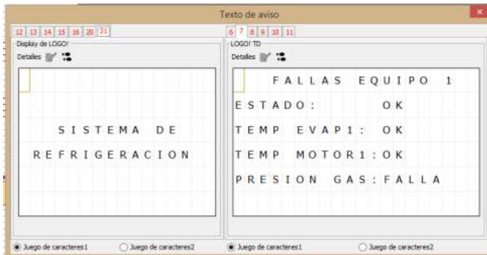
Figura 3.21: Visualización de falla por fuga de gas refrigerante. Nota: Simulación de sistema propuesto.
