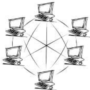
Figura 2.10: Topología de tipo Malla. Nota: Obtenido de (Zúñiga, 2015).
