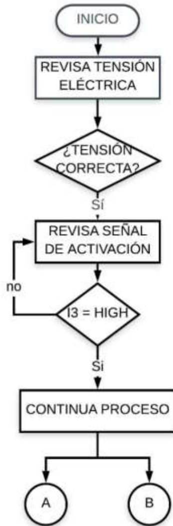
Figura 3.5: Diagrama de flujo de control de PLC LOGO. Nota: Se denotan la inicialización y revisión inicial de estados.
