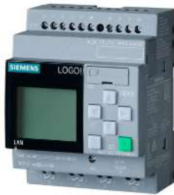
Figura 2.15: Logo V8.2 con conexión a ethernet. Nota: Obtenido de (SyS, 2018).
