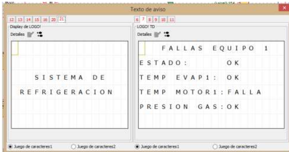
Figura 3.20: Visualización de falla por recalentamiento de motor en Logo TD. Nota: Simulación de sistema propuesto.
