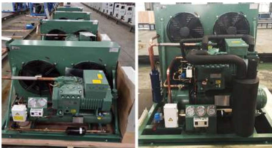
Figura 2.2: Equipo Condensador de Sistema de Refrigeración. Nota: Obtenido de (CRYO SYSTEMS, 2018)
