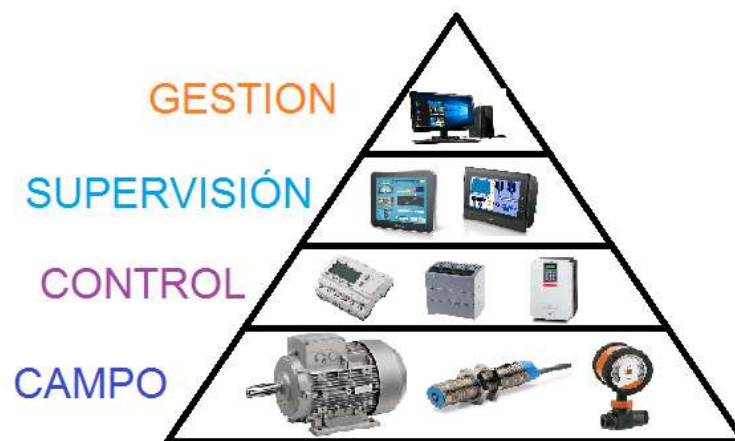
Figura 2.6: Pirámide representativa a los niveles de la Automatización. Nota: Obtenido de (Says & Rojas, 2017) y modificado por Autor.
