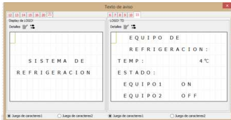
Figura 3.16: Ventana de estado de equipos accionados en operación normal. Nota: Simulación de sistema propuesto.
