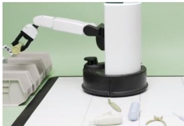
Figura 2.22 Mano Robótica "Pinza", depositando el objeto. Fuente: (Mae et al., 2018)
