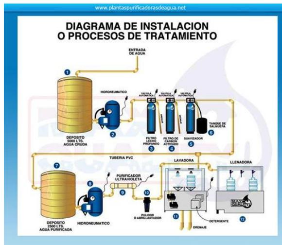
*Fuente: Planta de Agua Esquemático, Instapura 2008*
