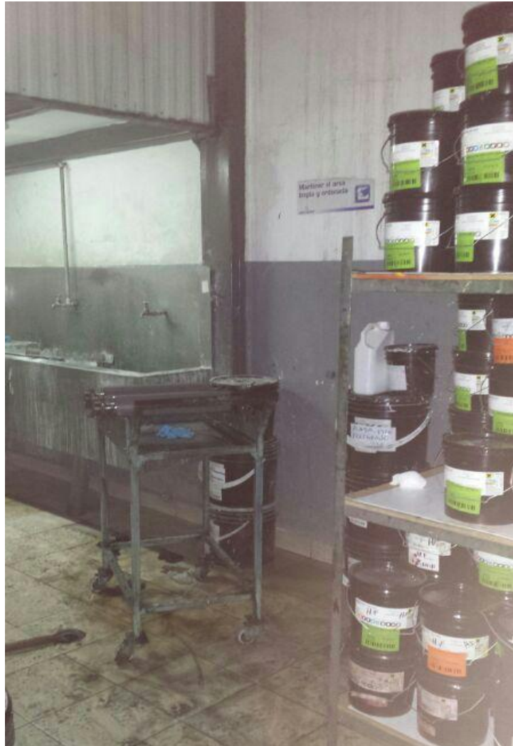
Gráfico 4.9 - Tintas amontonadas y bandeja para cambio de tinta móvil ubicada incorrectamente
