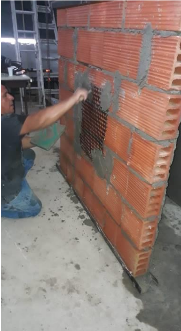
Ilustración 24: panel mampostería reforzado con fibras de carbono, lab. Estructuras UCSG, Edward Badillo, 2020
