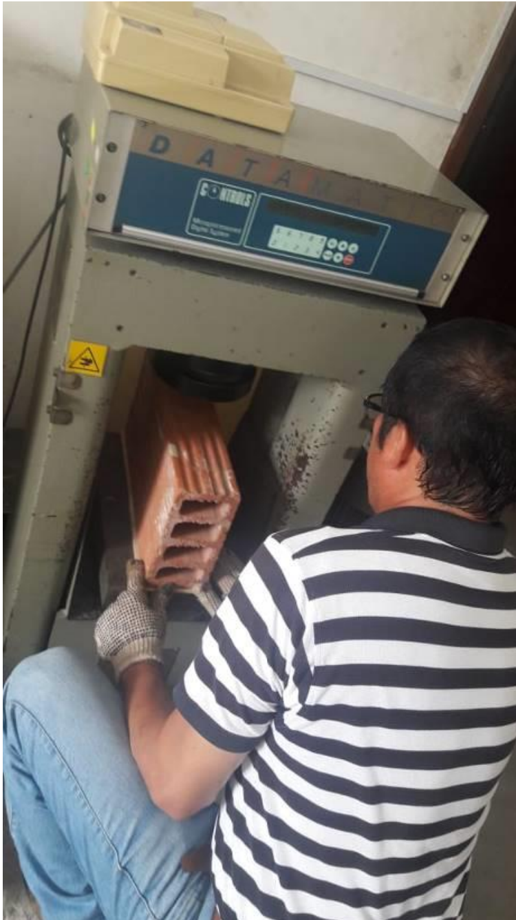
Ilustración 1: Ensayo a compresión, laboratorio de estructuras, UCSG, Edward Badillo
