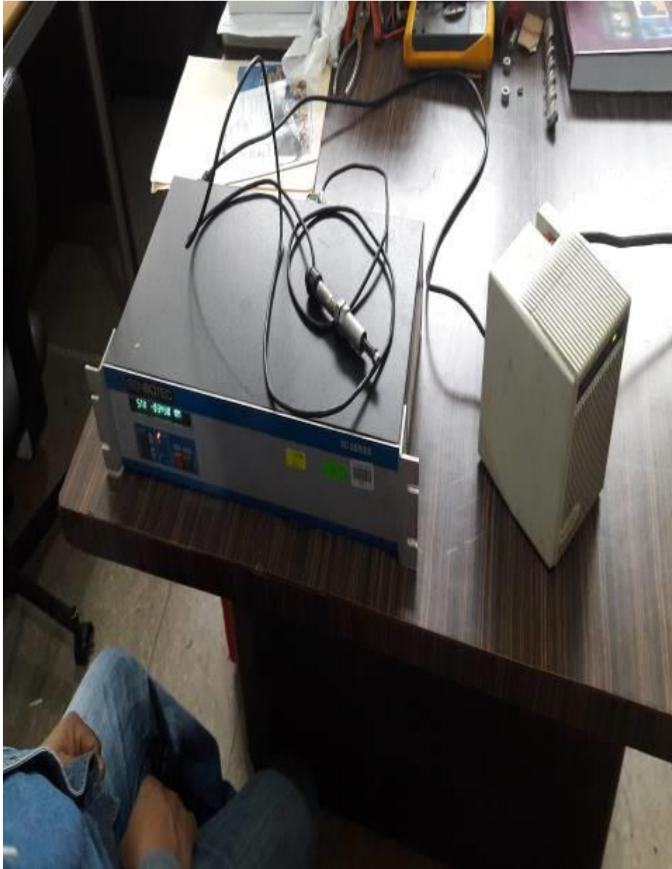
Ilustración 20: Consola electrónica que procesa los impulsos, lab. Estructuras UCSG, Edward Badillo, 2020
