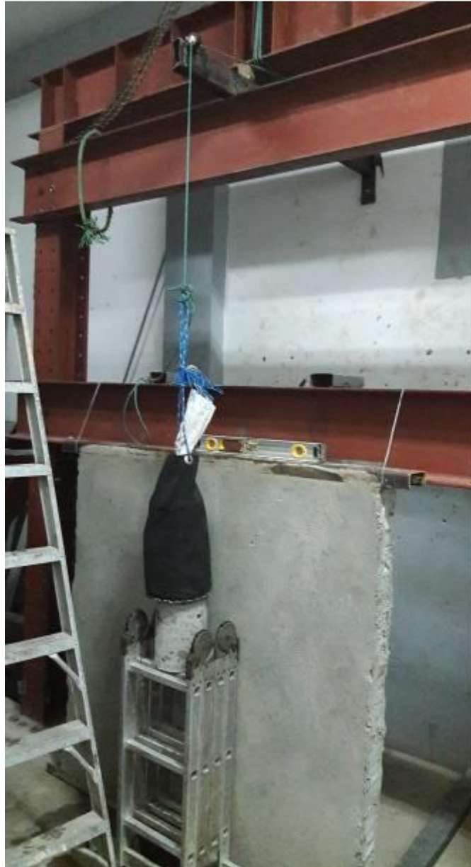
Ilustración 21: Instalación de masa de impacto, lab. Estructuras UCSG, Edward Badillo, 2020
