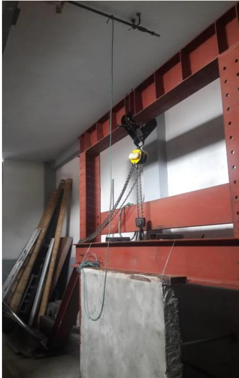
Ilustración 17: panel mampostería ajustado para la prueba de impacto, lab. Estructuras UCSG, Edward Badillo, 2020
