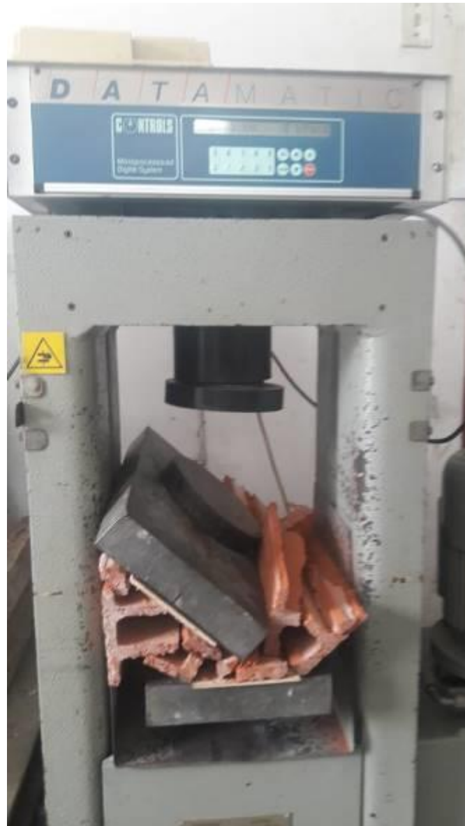
Ilustración 4: Falla a compresión del bloque, lab. de estructuras, UCSG, Edward Badillo
