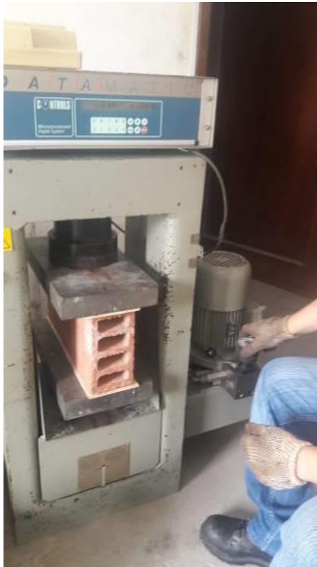
Ilustración 3: Ensayo del bloque a compresión, lab. De estructuras, UCSG, Edward Badillo
