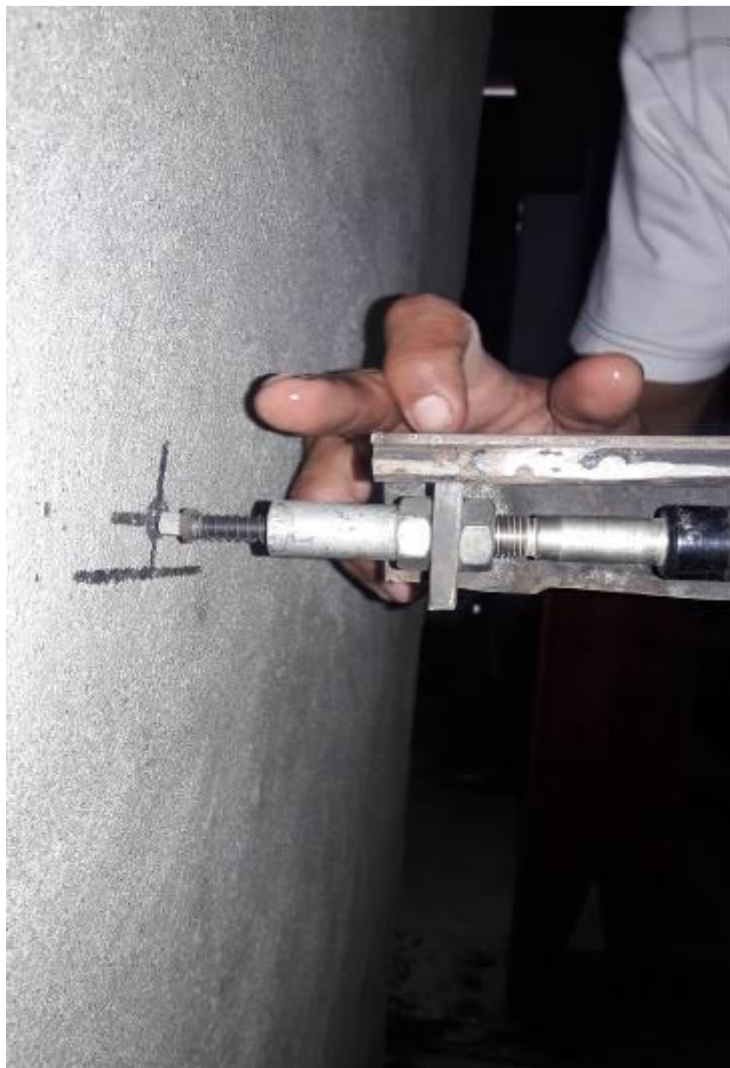
Ilustración 19: Sensor electrónico LVDT, lab. Estructuras UCSG, Edward Badillo, 2020
