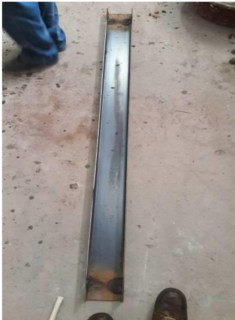
Ilustración 15: Perfil metálico tipo U125x50x25x3, lab. Estructuras UCSG, Edward Badillo, 2020
