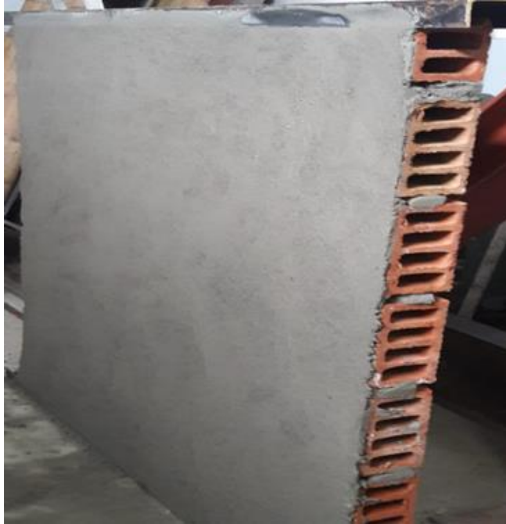
Ilustración 8: panel mampostería sin refuerzo, lab. Estructuras UCSG, Edward Badillo.
