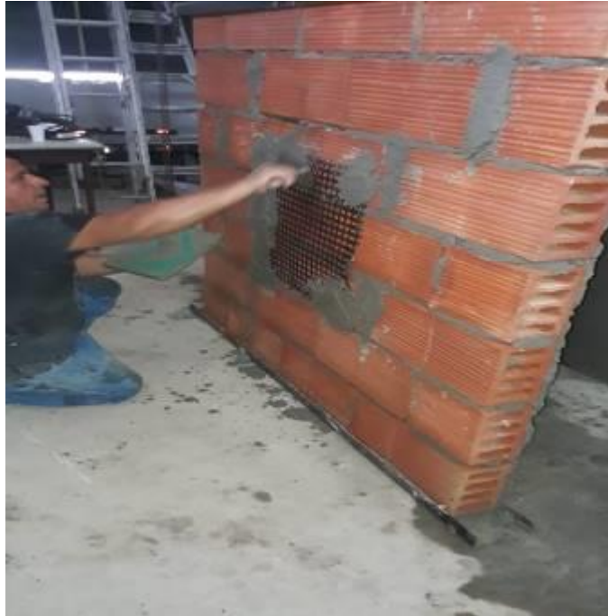
Ilustración 9: panel mampostería con refuerzo de malla de fibra de carbono, lab. Estructuras UCSG, Edward Badillo.
