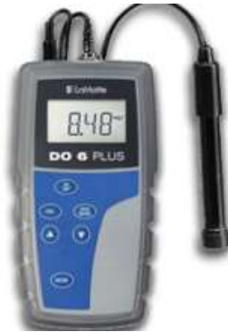
Figura 21 Medidor de oxígeno Adaptado de Boyd, C., Kwei, C., & Pantoja, C. (2005). Coastal Resources Center . Coastal Resources Center.
