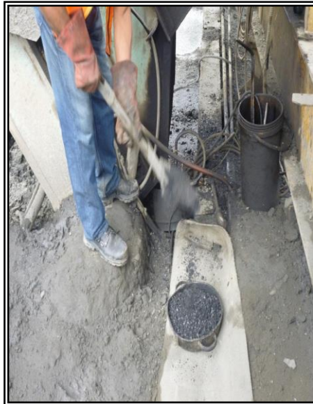
Fig. 10: Extracción de muestras desde planta.
