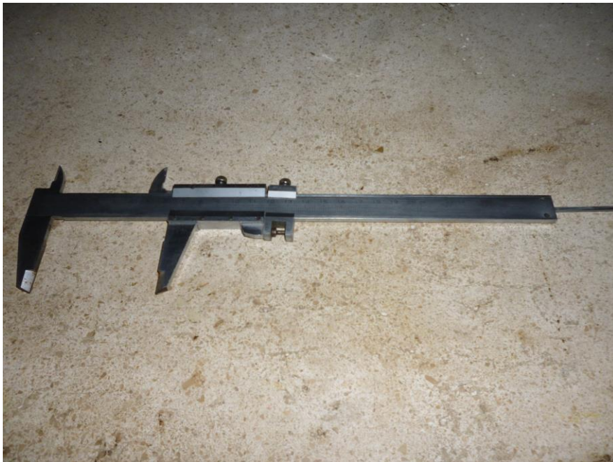
Fig. 18: Calibrador vernier o pie de rey.
