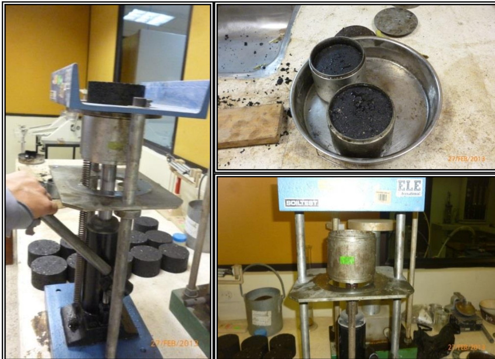
Fig. 15: Extractor de muestras o briquetas.
