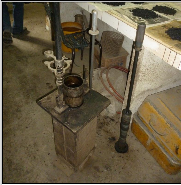
Fig. 13: Compactadores manual y automático.
