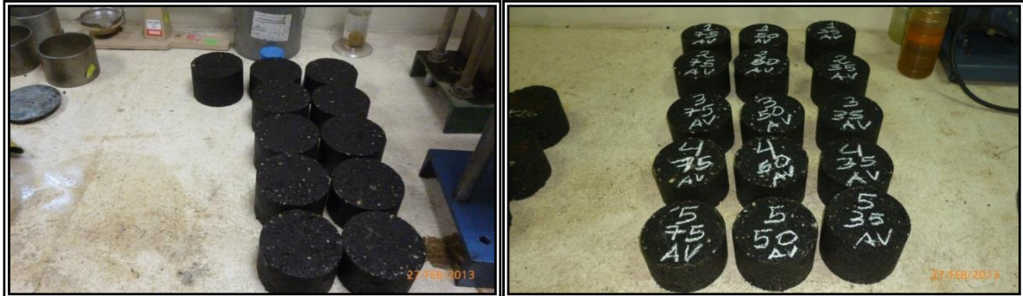
Fig. 16: Etiquetado de briquetas.
