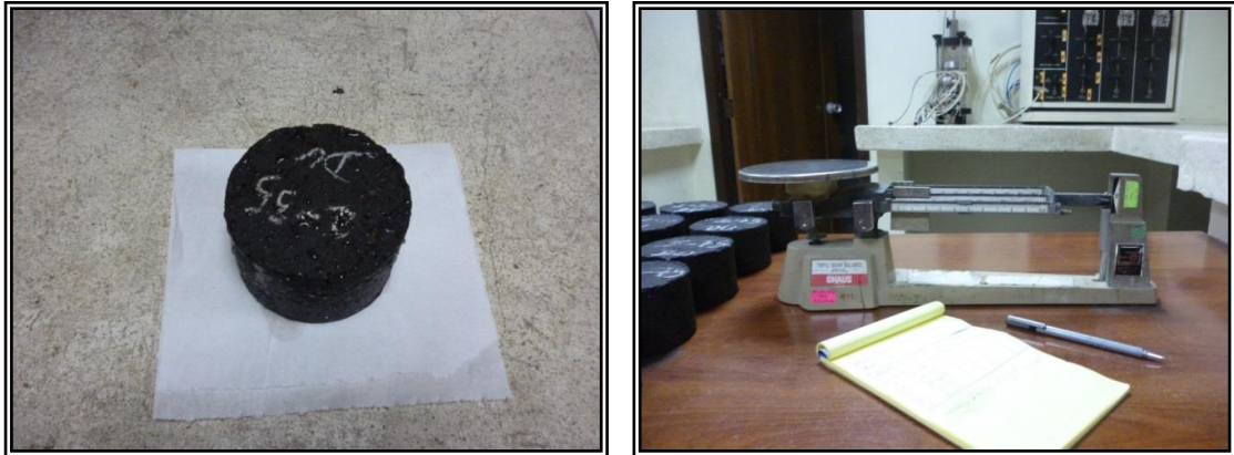
Fig. 21: Peso con superficie superficialmente seca.
