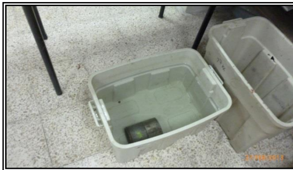
Fig. 14: Enfriamiento de briquetas.
