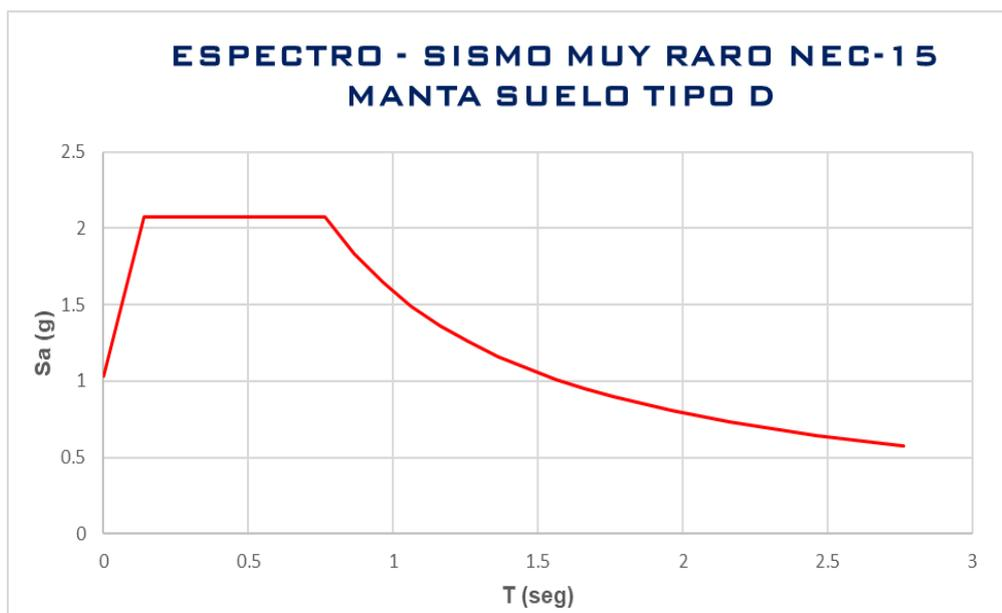
Ilustración 89. Espectro de respuesta de diseño para sismo muy raro, Manta suelo tipo D.
