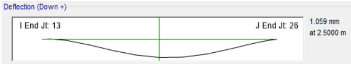
*Figura 4.22. Deflexión máxima de viga del eje C entre ejes 3 y 5 (viga cargadora) en los pisos 3 y 4. Viga de 300 mm x 550 mm.*
