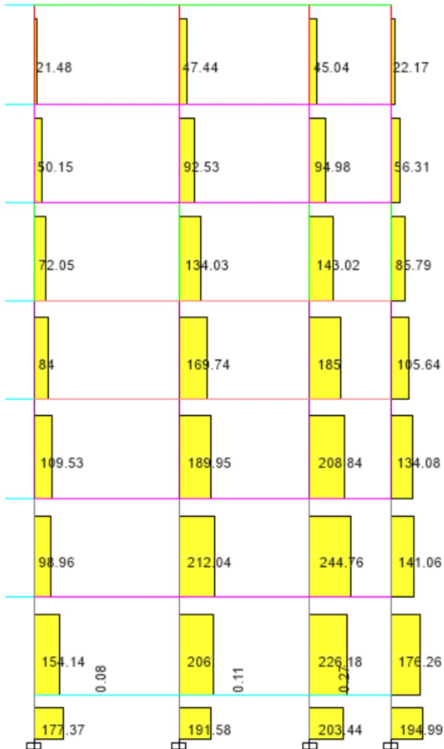
Figura 5.3. Diagrama de fuerzas cortantes del pórtico del eje D del edificio del primer caso sometido a la fuerza sísmica  $E_y$ . Unidades: kN.
