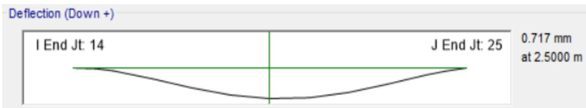
*Figura 3.23. Deflexión máxima de viga del eje D entre ejes 3 y 5 (viga cargadora) en los pisos 3 y 4.*
