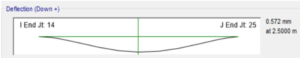
*Figura 3.22. Deflexión máxima de viga del eje D entre ejes 3 y 5 (viga cargadora) en los pisos 1 y 2.*
