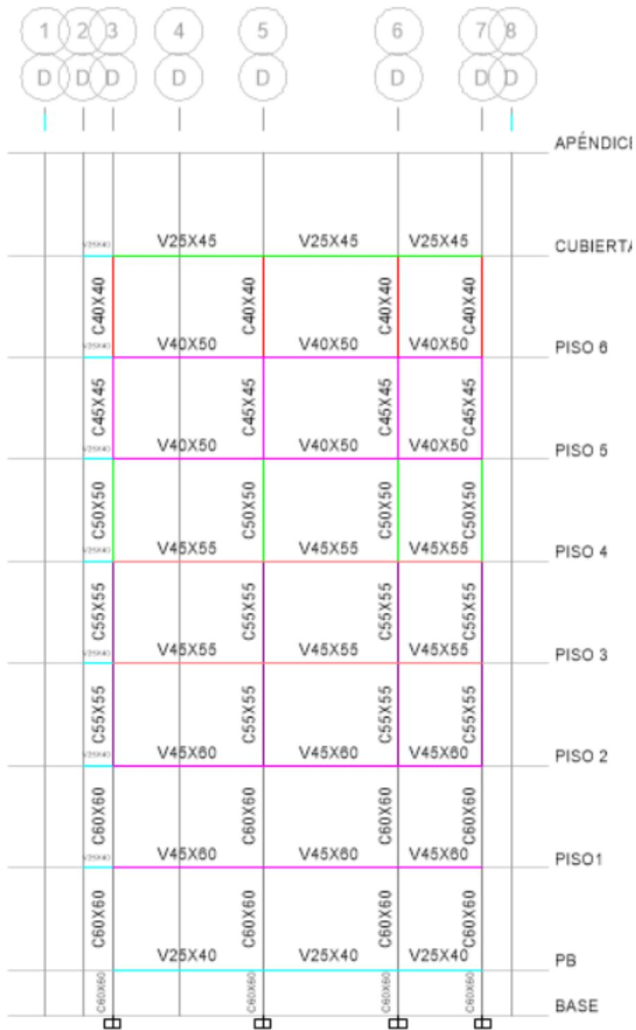
Figura 3.8. Alzado del pórtico del eje D. Se puede constatar lo indicado en la Tabla 3.3.
