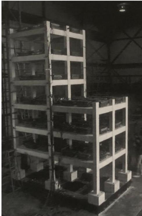
*Figura 1.7. Edificio a escala de pórticos especiales a momento ensayado por el profesor Jack Moehle. (Moehle J. P., 2015).*
