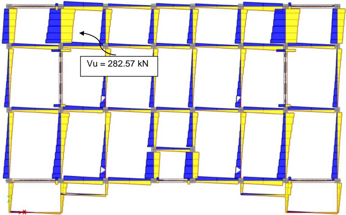
Figura 4.38. Diagrama de cortante  $V_{22}$  del piso 3 a partir de la envolvente de cortantes.
