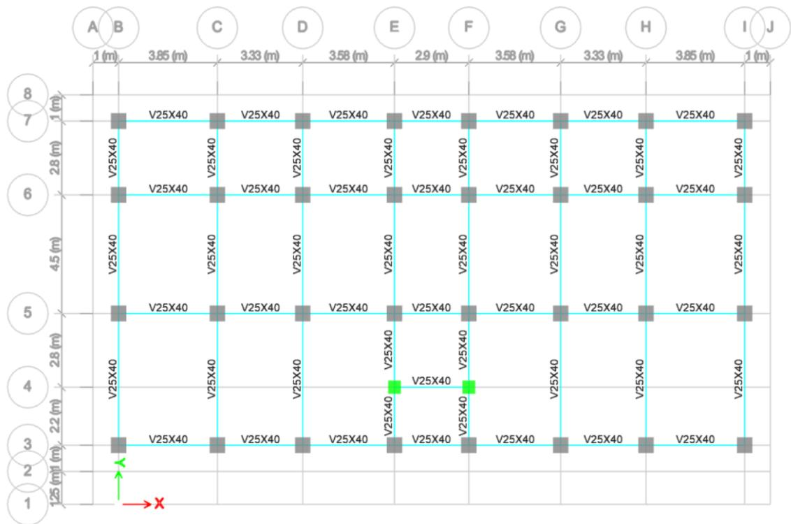
Figura 3.2. Vigas de planta baja (Nivel: +0.00 metros).
