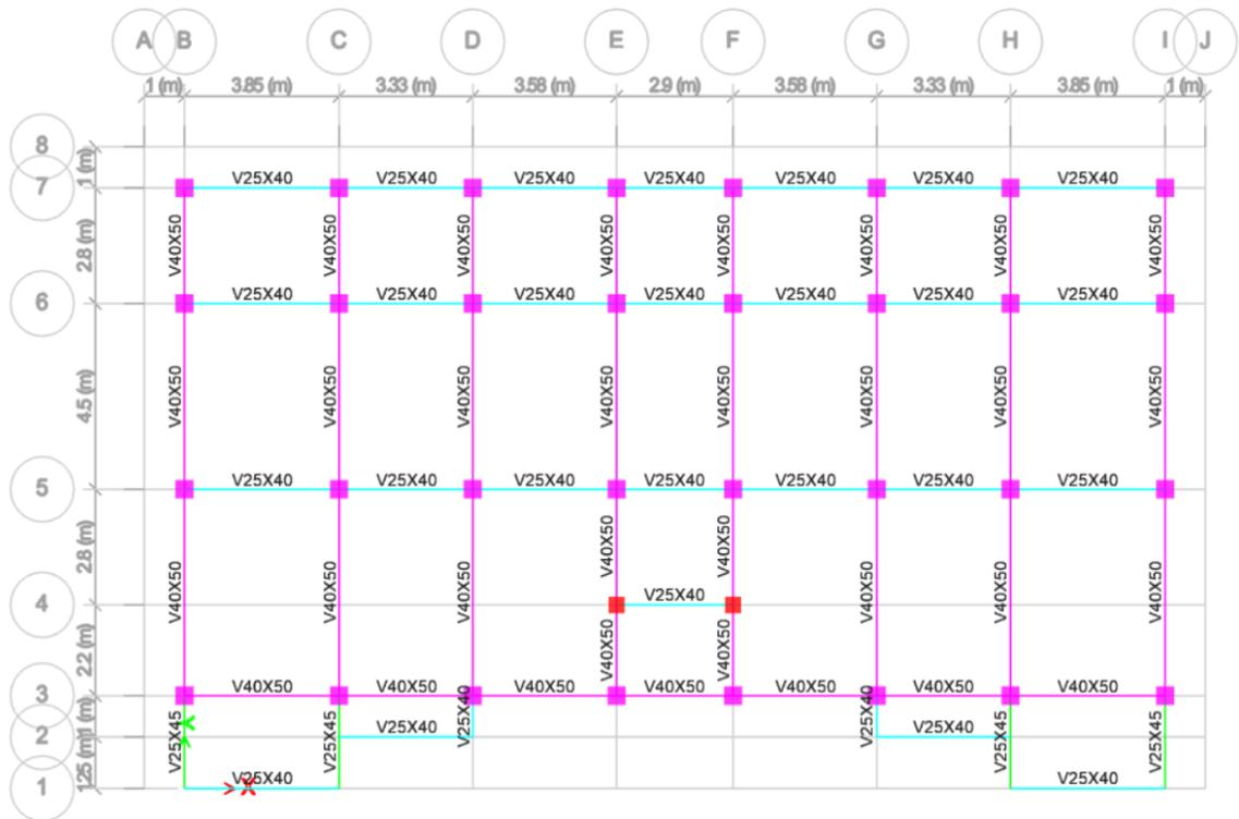
Figura 3.5. Vigas de los pisos 5 y 6 (Nivel: +17.00 y +20.40 metros).
