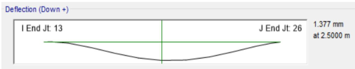
*Figura 4.23. Deflexión máxima de viga del eje C entre ejes 3 y 5 (viga cargadora) en los pisos 5 y 6. Viga de 300 mm x 500 mm.*
