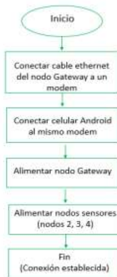
Figura 3. 22: Conexión del sistema doméstico
