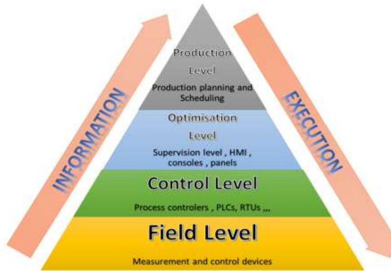
Figura 2. 12: Arquitectura de un sistema de control distribuido
