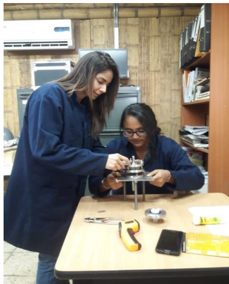
Figura 3.16. Colocación de las pastillas de roca en el sistema de agarre
