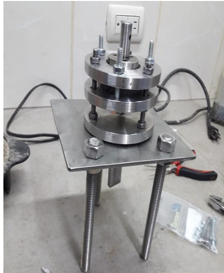
Figura 3.15. Nuevo sistema de agarre para ensayo de adherencia entre el ligante asfáltico y el agregado mineral
