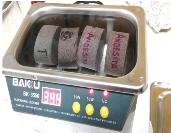
Figura 3.5. Lavado ultrasónico de las pastillas de roca
