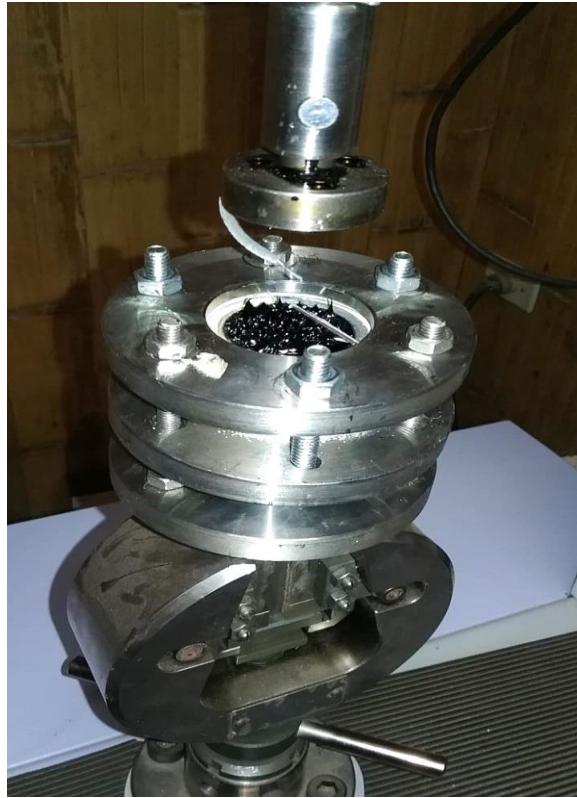
Anexo 7.1. Área con fallo por cohesión (vista desde el sistema de agarre)
