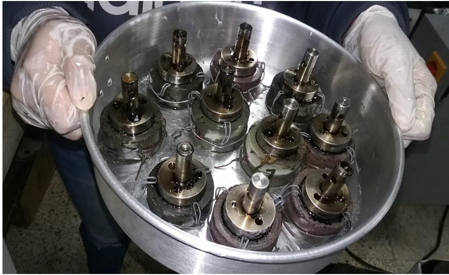
Figura 3.22 Climatización del sistema pistón - pastillas de roca
