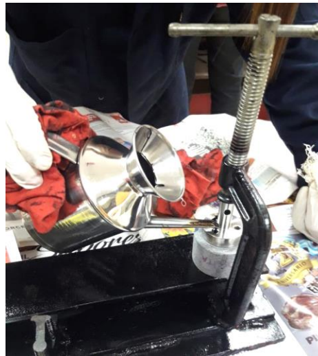
Figura 3.12. Colocación del ligante asfáltico en las aberturas del pistón
