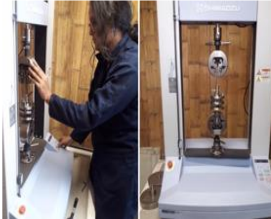
Figura 3.17. Ajuste del sistema de agarre con la prensa hidráulica
