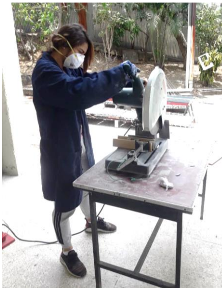
Figura 3.2. Proceso para cortar los núcleos de las rocas en forma de pastillas
