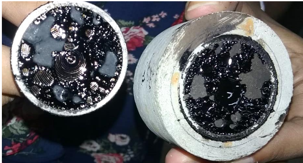
Anexo 7.3. Área con fallo por adherencia
