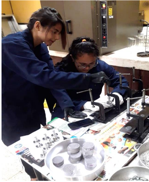
Figura 3.9. Ajuste de las pastillas de roca con el pistón en prensas manuales
