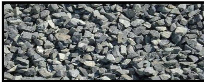
Figura 21. Muestra de piedra triturada.
