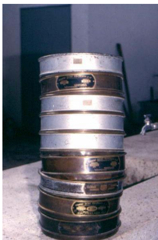
Figura 22. Foto de tamices que se usan en el ensayo de granulometría.
