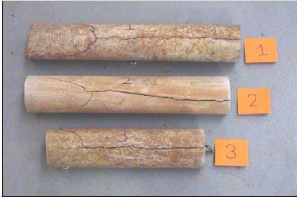
Ilustración 7. Fallas en tuberías de asbesto cemento
