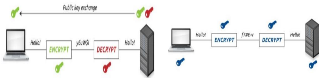
Figura 2 Diferencia entre cifrados asimétrico y simétrico generados por el SSL. Obtenido en https://ieeexplore.ieee.org/document/8447634
