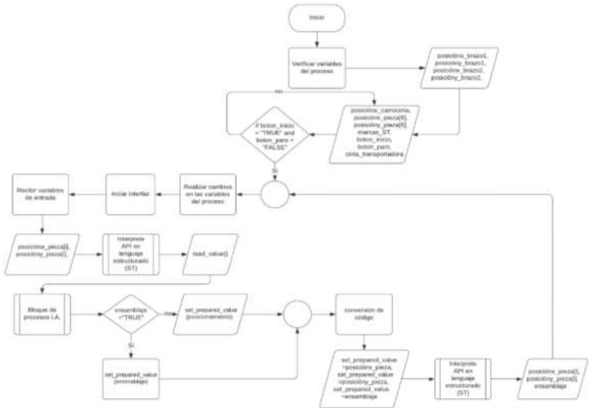
Fig. 3.23. Diagrama de flujo de la implementación del algoritmo de I.A. en CODESYS
