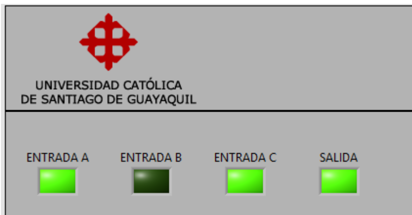
Figura 3. 40: Resultado obtenido en la práctica 1 cuando A=C=1 y B=0 . Elaborado por: Autor.
