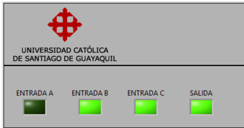
Figura 3. 39: Resultado obtenido en la práctica 1 cuando A=0 y B=C=1 . Elaborado por: Autor.
