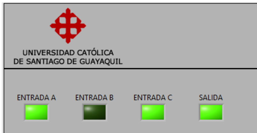
Figura 3. 44: Resultado obtenido en la práctica 2 cuando A=B=C=1 . Elaborado por: Autor.
