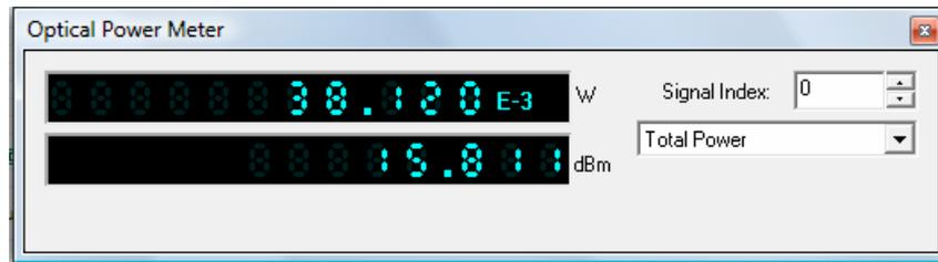
Figura 3. 26: Potencia de la señal salida del EDFA.
