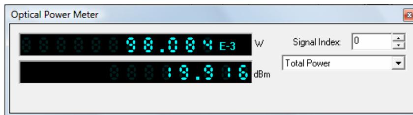
Figura 3. 11: La potencia de la salida del amplificador óptico semiconductor.
