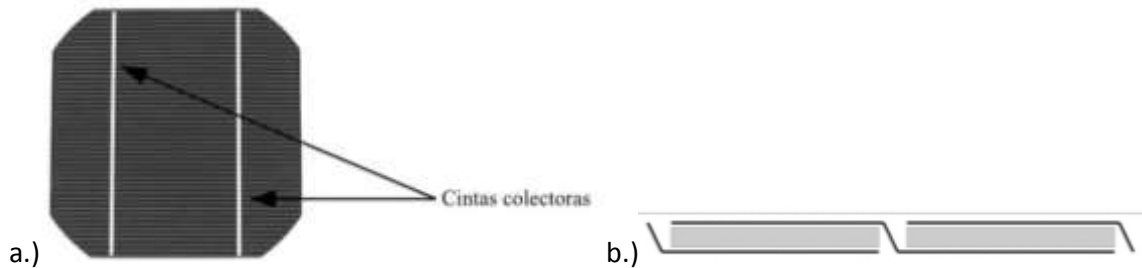
Figura 2.35 a.) Cintas colectoras; b.) Conexión entre células.
