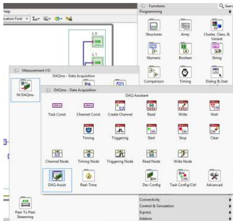
Figura 3. 22: Conexión de tarjeta de adquisición de datos DAQ
