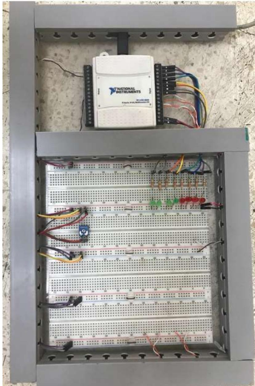
Figura 3. 33: Armado de circuito con tarjeta DAQ.
