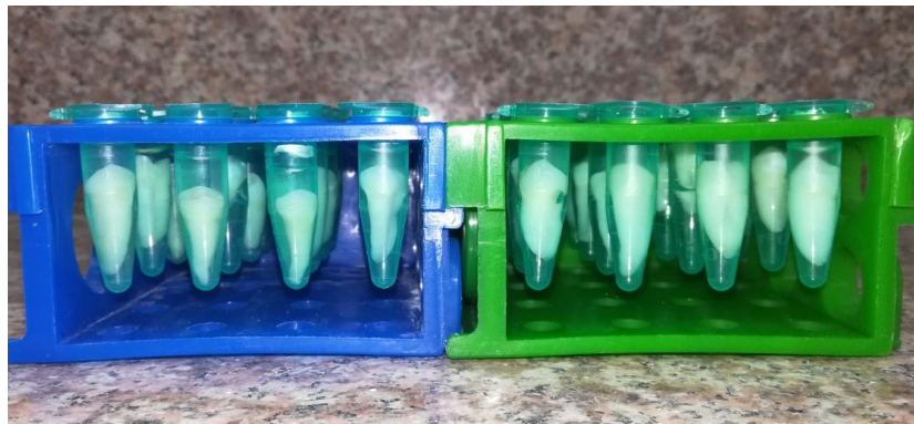
Imagen 11. Se realizó proceso de termociclado de 500 ciclos en un termobloque: AccuBlock Digital Dry Bath-Labnet a tres temperaturas 55°C, 37°C y 5°C, durante 30 segundos.
