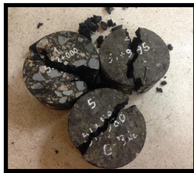
Figura 25. Núcleos de las vías de la región Sierra ensayados a Fatiga
