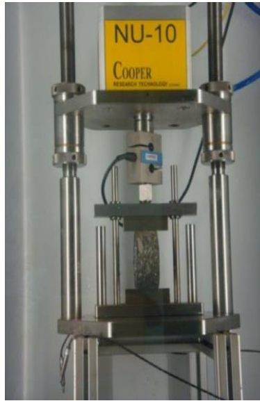
Figura 1.4 Prueba de fatiga bajo dispositivo de tracción indirecta
