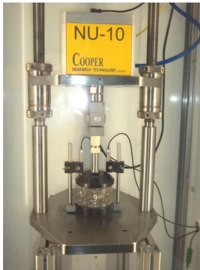
Figura 1.5 Compresión cíclica uniaxial sin confinamiento (Creep dinámico)
