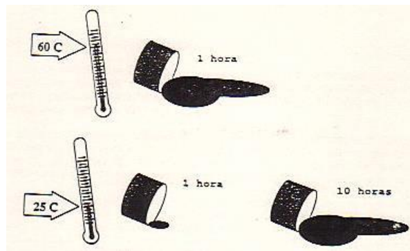
Figura 3.6: Dependencia tiempo – temperatura del cemento asfáltico. Fuente: Taller sobre mezclas asfálticas rígidas, recicladas y micro-pavimentos. Editorial EMOP-Q, 1997
