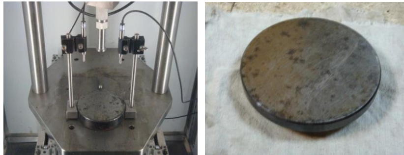
Figura 6.21: Equipos para el ensayo del creep dinámico
