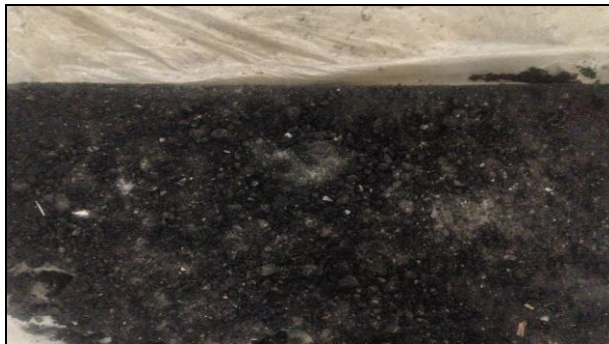
Figura 2: Mezcla asfáltica muestreada en planta.
