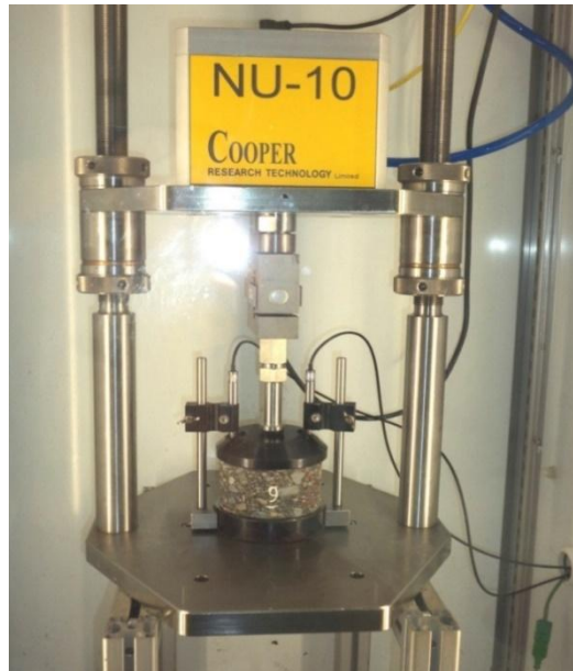
Figura 17. Prueba de compresión bajo carga repetida en N.A.T.
