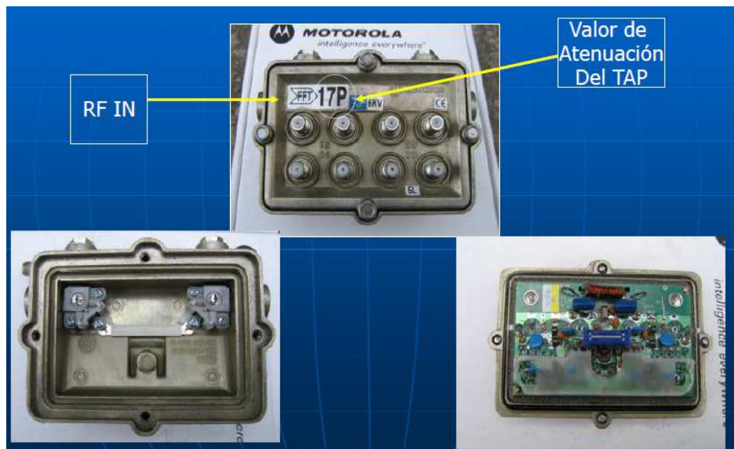
Figura 2.20 Taps para redes HFC. Fuente: (Arris, 2019)
