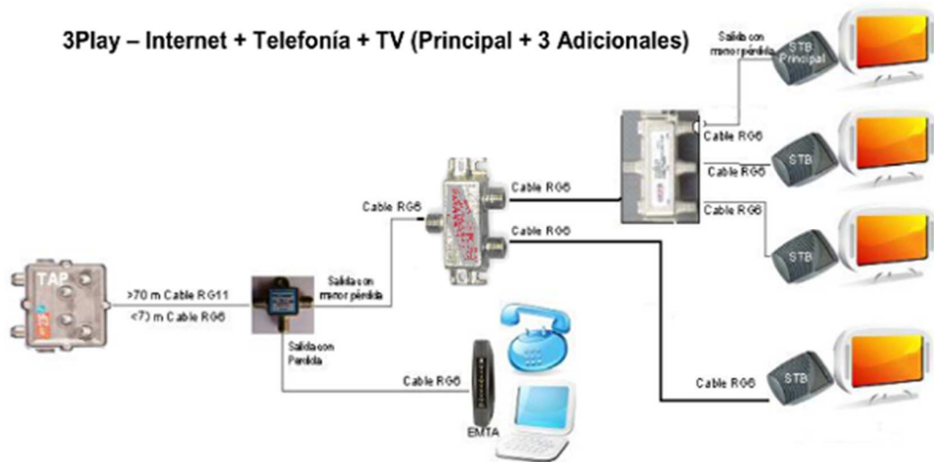
Figura 2.5 Red de acometida HFC. Fuente: (Arris, 2019)
