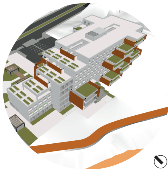
Uso de paneles a base de bloques de hormigón y ventanales móviles para permitir permeabilidad en el proyecto.
