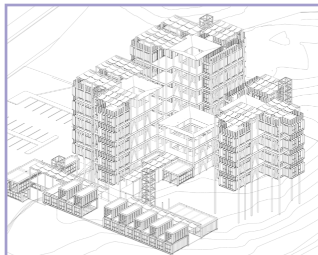
Módulos habitacionales de containers color blanco colocados y fijados a la estructura.
