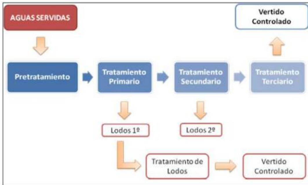
Fig. No. 7 Secuencia de tratamiento de aguas residuales domésticas
