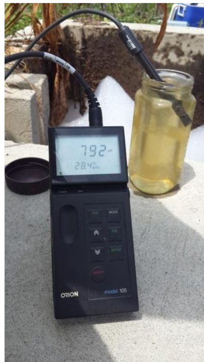
Foto No.13: Medición de Conductividad (afluente – Efluente)
