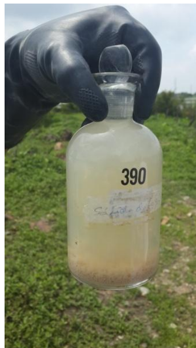
Foto No.11: Verificación de que no hay Oxígeno Disuelto afluente
