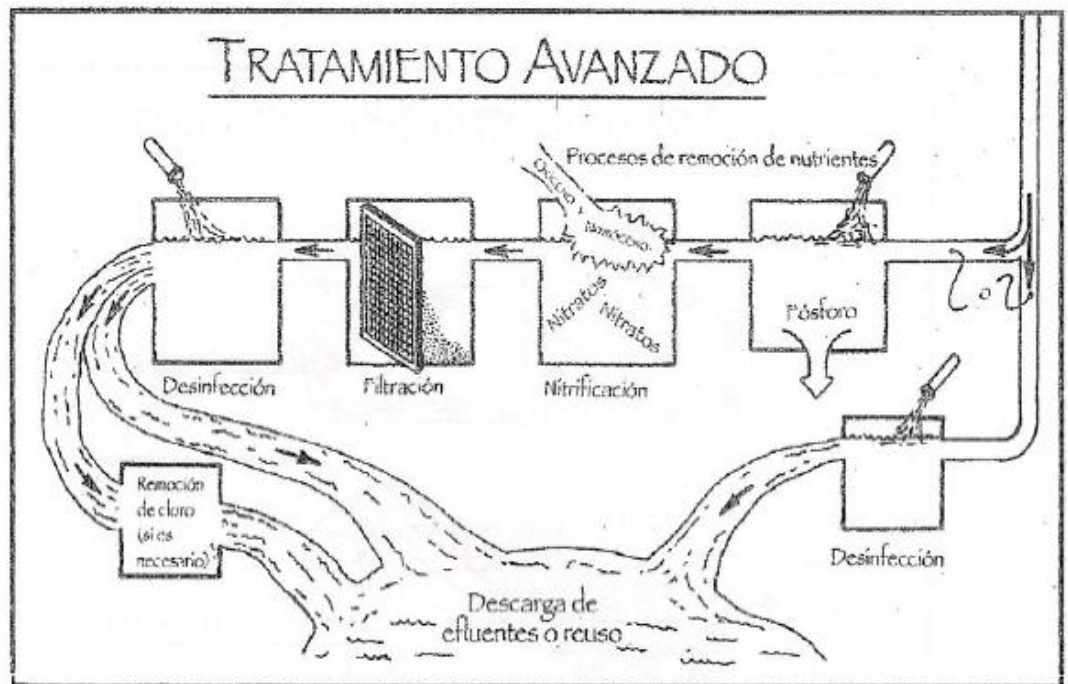
Fig. No. 6 Tratamiento terciario - avanzado (Aguas residuales)
