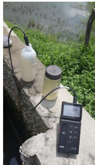
Foto No.13: Medición de Conductividad (afluente – Efluente)
