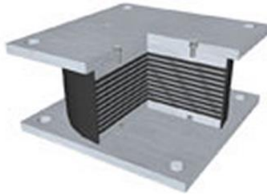
FIGURA 2: APOYO ELASTOMERICO CON PLACAS DE ACERO
