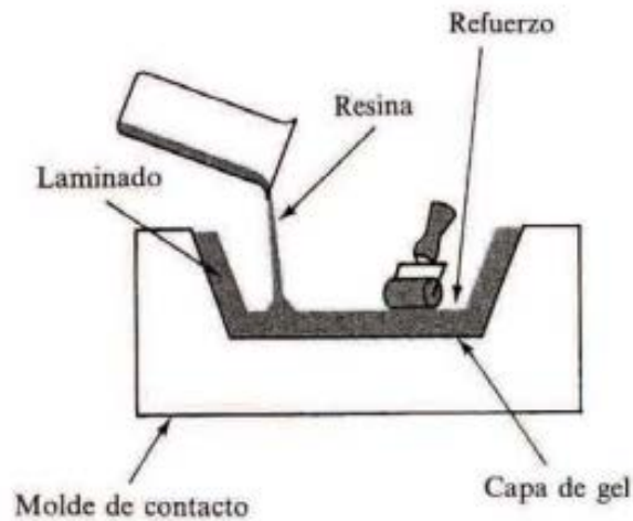
Figura No. 1: Vertido de la resina sobre el refuerzo en el molde
