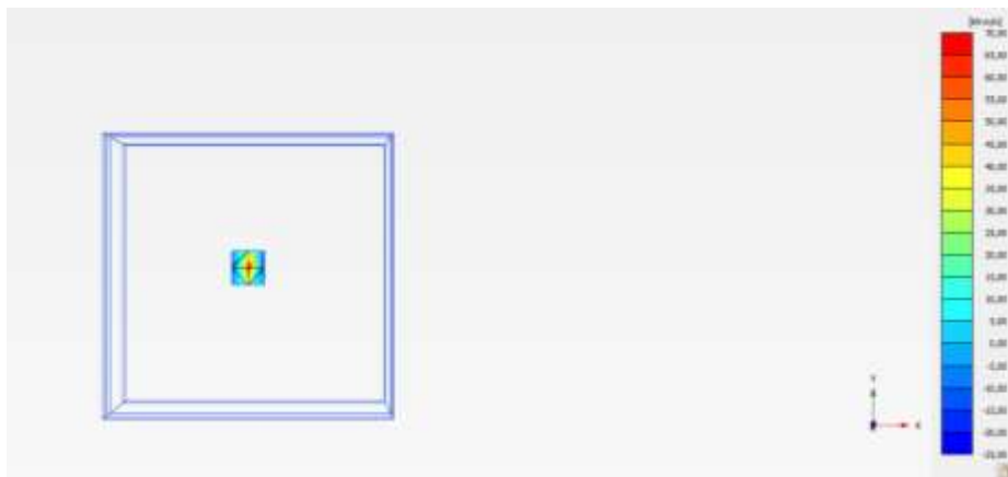
Figura 52. Momento M_{11} de zapata aislada.
