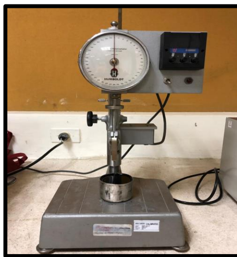
Figura 6. Ensayo de penetración Fuente: Autores
