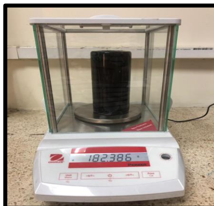
Figura 11. Ensayo cambio de masa Fuente: Autores
