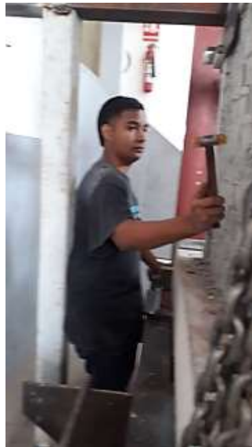
Ilustración 35. Aplicación de vibración forzada mediante golpes con martillo de goma.
