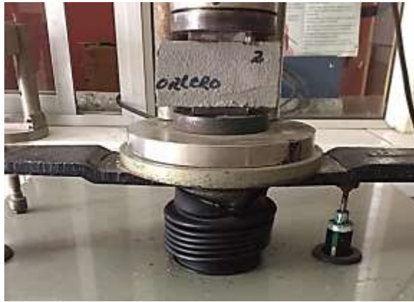
Ilustración 16. Ensayo de compresión usando el sobrante del ensayo a flexión.
