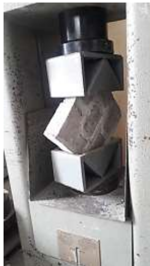
Ilustración 22. Ensayo de Compresión Diagonal.
