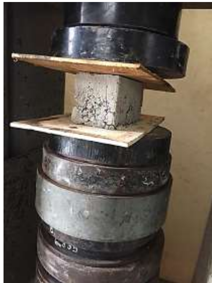
Ilustración 19. Ensayo del Bloque.
