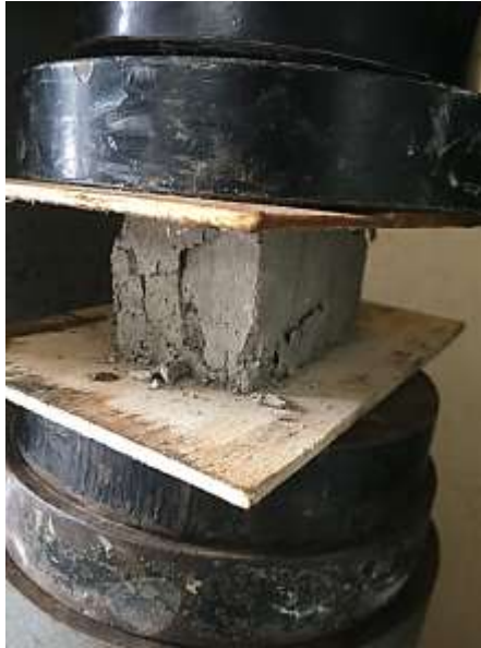
Ilustración 20. Forma de Falla.
