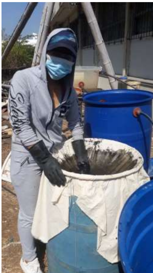
Ilustración 18 Recolección de lodos residuales obtenidos de la planta piloto
