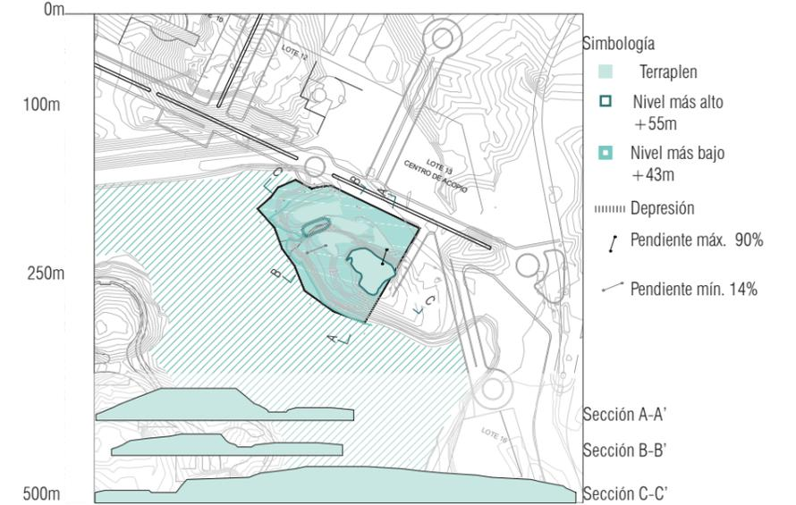
El terreno presenta diferencias de nivel muy pronunciadas de hasta 12m, en las cuales se pueden identificar terraplenes que pueden utilizarse para implantar el proyecto.
