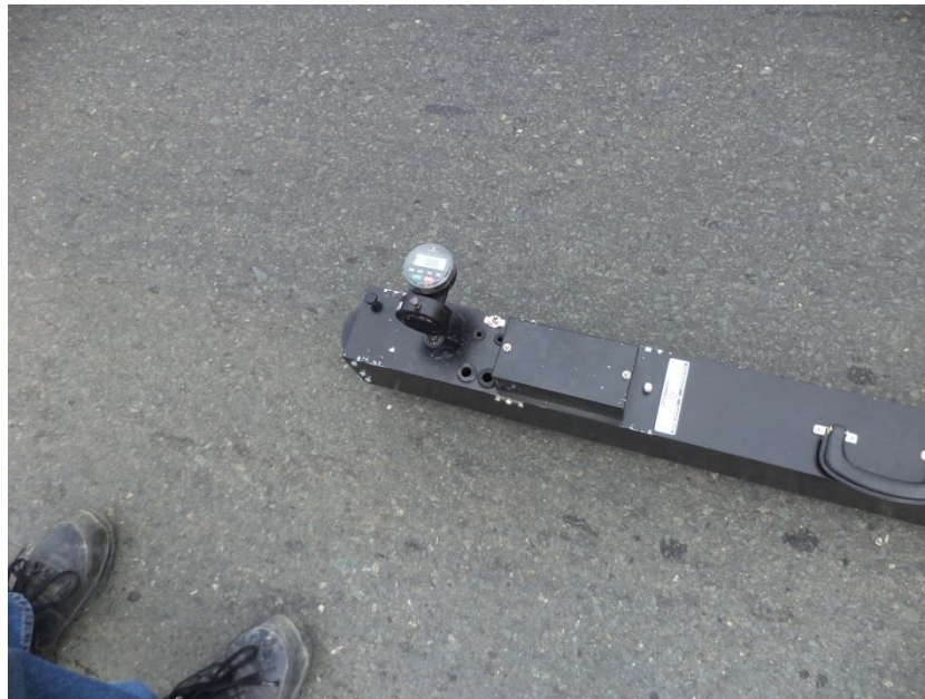
Figura 5.7 Viga Benkelman con dial de deformación digital
