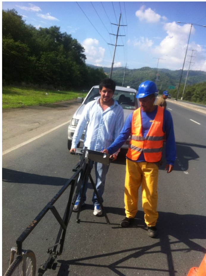
Figura 5.4 Medición de regularidad de pavimento utilizando el MERLIN
