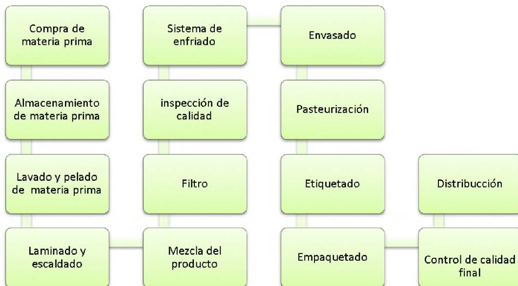
Figura 3. Proceso de producción de la bebida de jengibre. Elaborado por: Las autoras.
