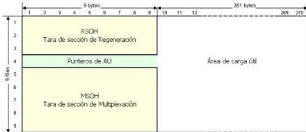
Fig. 3 Estructura de Trama del STM-1 Fuente: Autores
