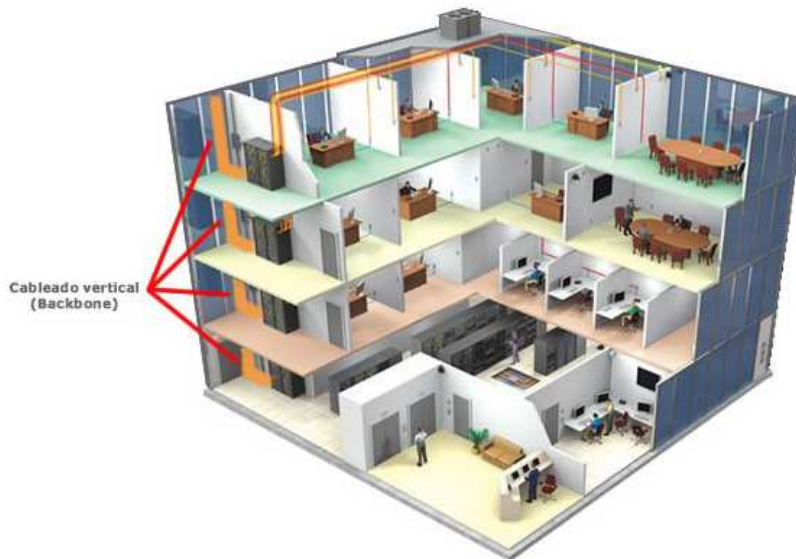
Figura 2.31: Representación del sistema de cableado vertical
