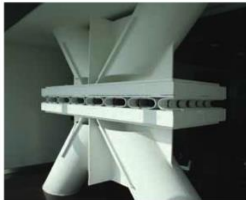
Figura 46 Disipador de Energía por Rolado en U en la Torre Titanium, Chile (Corporación de Desarrollo Tecnológico-Cámara Chilena de la Construcción, 2011)
