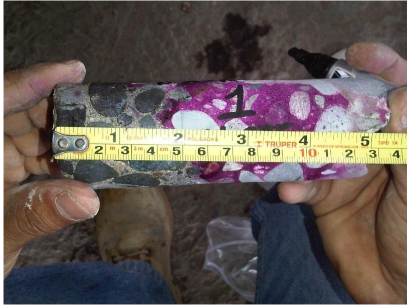
Figura 15 Medición de la profundidad de la carbonatación
