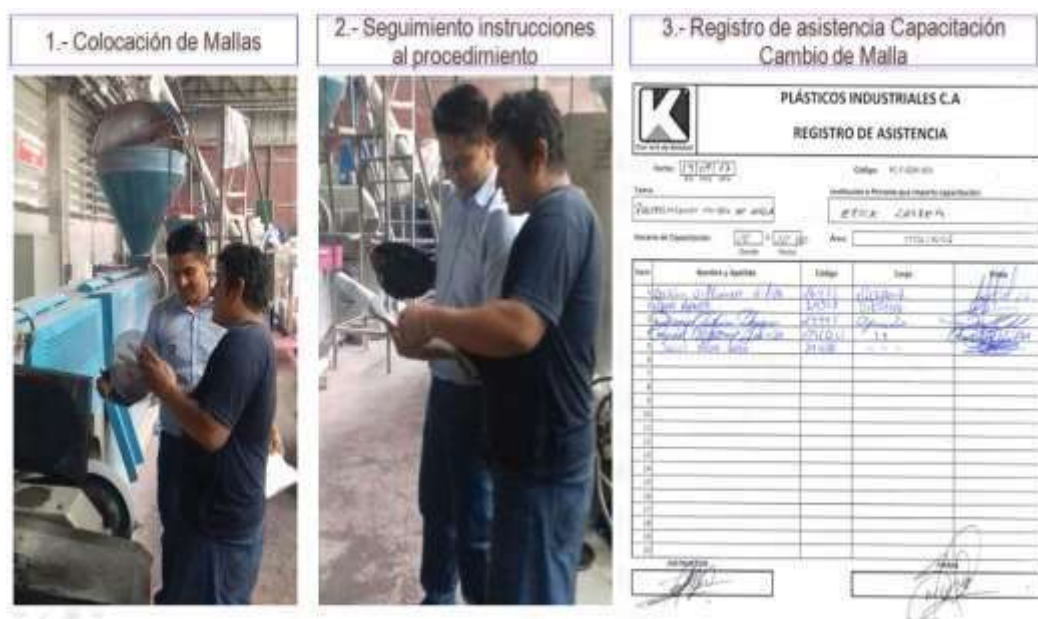
Figura 27. Cambios de mallas de la peletizadora.
