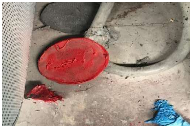
Figura 32. Malla contaminada extraída y expuesta al ambiente.
