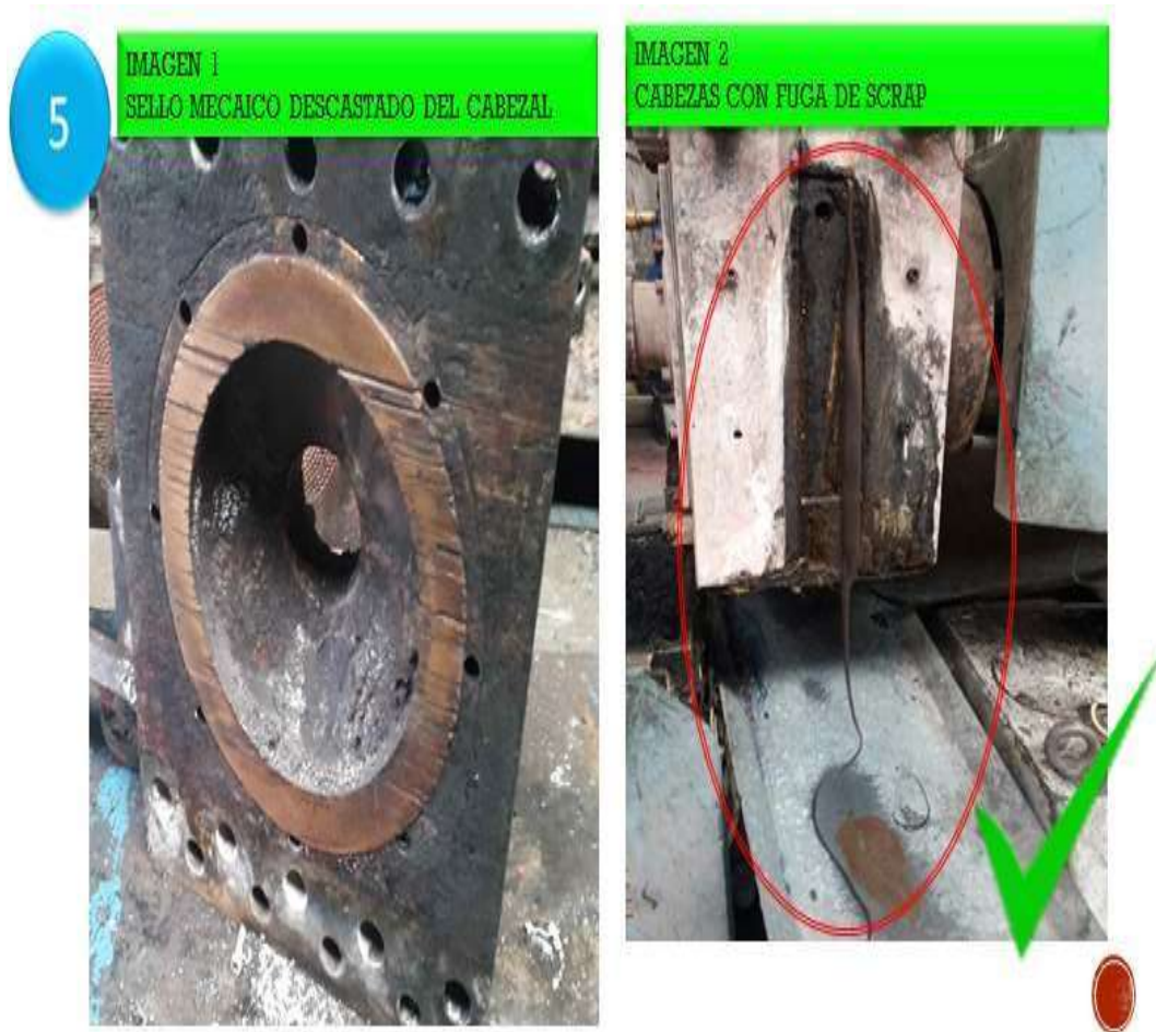
Figura 19. Verificación de causa raíz de scrap por cabezal de peletizadora en mal estado.
