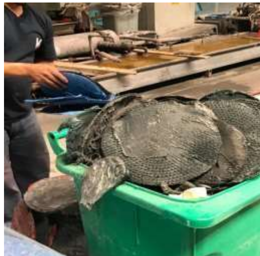
Figura 34. Operador colocando la malla contaminada en el recipiente del proveedor de limpieza
