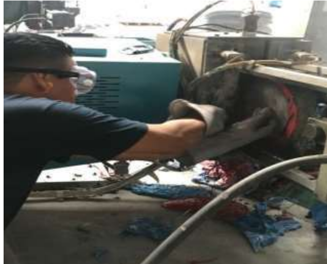
Figura 33. Operador colocando la malla nueva en el otro porta malla del cabezal.
