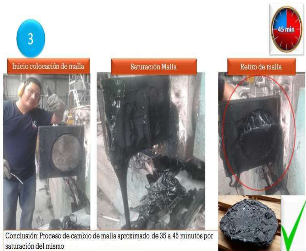
Figura 17. Verificación de causa raíz de scrap por desgaste del cabezal de la peletizadora.
