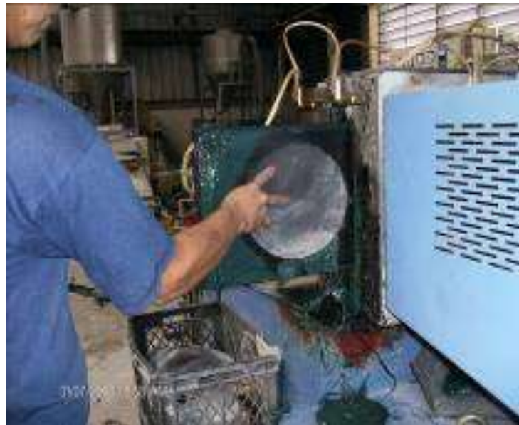
Figura 42. Colocación de mallas en él porta filtro.
