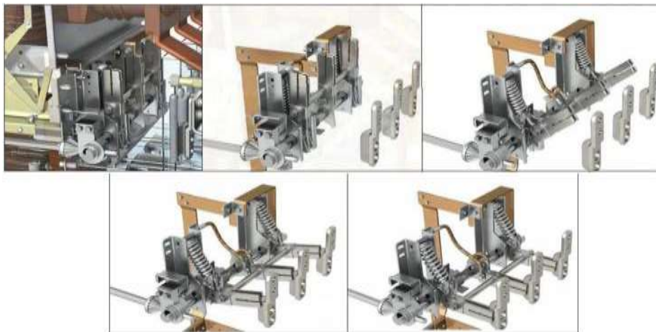
Figura 2. 24 Secuencia de cerrado de seccionador de puesta a tierra
